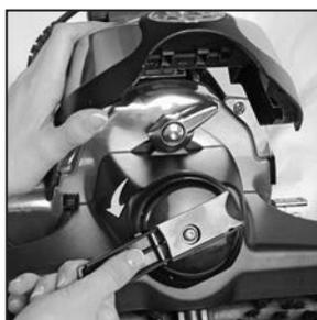
**5** Levante la cubierta de la luz frontal. Gire el mecanismo de elevación de la correa hacia la izquierda hasta que se alineen las flechas rojas.
