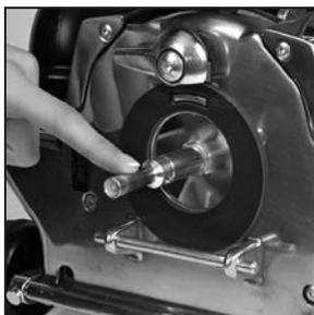
Mantenga el eje del motor limpio de pelusas, cabellos o de cualquier acumulación de residuos.
