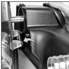
**9** Conecte los ganchos de la parte trasera del sistema de lavado multisuperficie a la barra de acoplamiento.
