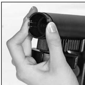
**3** Saque el tubo de inyección presionando los dos pasadores de su parte delantera y lávelo bien. Llene de agua el recipiente, vuelva a acoplarlo y pulverice agua hasta que salga limpia.
