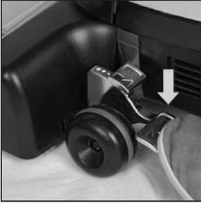
**5** Pise varias veces el pedal superior del pulsador para el dedo del pie hasta que el cepillo cilíndrico para juntas y baldosas toque el suelo. Mueva el sistema limpiador a la zona que deba limpiarse. Pulverice más cantidad de producto de limpieza si es necesario.
