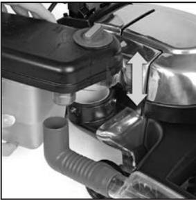
**17** Con cuidado de no derramar líquido sobre el sistema o el suelo, coloque la abertura en la parte inferior del depósito de lavado, encima de la salida de aire.
