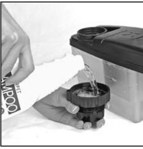
**15** El depósito de lavado debe llenarse y vaciarse en una pila o fregadero. Desenrosque el tapón grande que hay en la parte superior del depósito de lavado. Coloque la válvula de control del jabón en posición «OFF». Llene el depósito de agua tibia (no caliente) de acuerdo con el siguiente cuadro.
