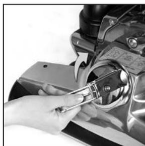
**8** Tire hacia fuera del mango del mecanismo de elevación de la correa para hacerlo girar hacia la derecha hasta que se alineen las flechas verdes. Así se enganchará la correa y permitirá que gire el cepillo cilíndrico. Consulte la página 17. Baje la cubierta de la luz frontal.
