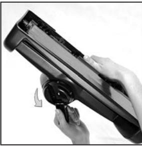
**7** Dele la vuelta al sistema de lavado multisuperficie. Al tiempo que tira hacia arriba de la correa con el dedo, gire hacia la izquierda el mecanismo de elevación de la correa usando el mango hasta que se alineen las flechas rojas. De este modo, el gancho del mecanismo de elevación de la correa atraparà la correa y esta se estirará.
