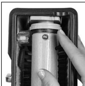
**2** Gire los extremos del cepillo cilíndrico hasta la posición deseada: niveles 1, 2 o 3. Asegúrese de que los dos extremos estén en la misma posición. Cuanto mayor es el nivel, más se extenderán las cerdas.
