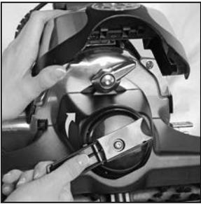
**12** Gire hacia la derecha el mecanismo de elevación de la correa del cabezal del sistema de lavado multisuperficie usando el mango hasta que se alineen las flechas verdes. Baje la cubierta de la luz frontal.
