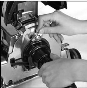
**5** Coloque los ganchos de la manguera auxiliar sobre la barra de acoplamiento. Presione la abertura de la manguera auxiliar contra la unidad. Gire el cierre auxiliar hacia la derecha para fijarlo en su sitio. Baje la cubierta de la luz frontal. Encienda la unidad.
