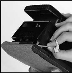
**2** Gire hacia arriba las palancas de la presilla que se encuentra en el lateral del accesorio turboaccionado. Introduzca una lámina de papel de lija en la presilla delantera y bloquee la palanca. Pegue el papel de lija a la parte inferior del accesorio turboaccionado hasta cubrirla, atrape el extremo con la presilla posterior y bloquéela.
