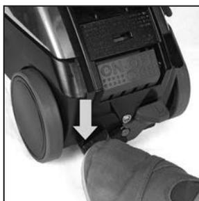
**2** Ponga el asistente de manejo TechDrive® en punto muerto pisando el lateral del pedal marcado con una «N». Así podrá mover la unidad hacia delante o hacia atrás con mayor comodidad cuando el motor esté apagado.
