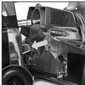
**7** Coloque los dos ganchos de la parte trasera del cabezal motorizado sobre la barra de acoplamiento de la parte delantera de la unidad. Presione el cabezal motorizado contra la unidad y fíjelo con el cierre auxiliar.
