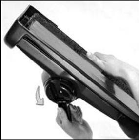
**7** Al tiempo que tira hacia arriba de la correa con el dedo, gire hacia la izquierda el mecanismo de elevación de la correa usando el mango hasta que se alineen las flechas rojas. De este modo, el gancho del mecanismo de elevación de la correa atraparé la correa y esta se estirá.
