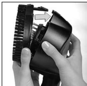
3 Vuelva a colocar la turbina en el accesorio y gírela hasta que las lengüetas encajen en las ranuras. Vuelva a encajar el anillo del cepillo en su sitio.
