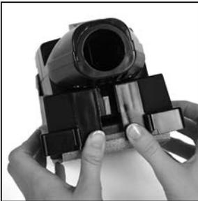
**3** Coloque el accesorio turboaccionado sobre una superficie nivelada y vuelva a acoplar la placa de protección frente al polvo de lijado con la abertura hacia la parte posterior. Inserte la manguera auxiliar.
