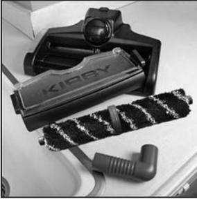
**8** Desmonte y limpie todas las piezas del sistema limpiador para suelos duros con una mezcla de amoníaco y agua al 50 % para eliminar todos los restos de Kirby Miracle Shine. Deje que las piezas se sequen antes de guardarlas. Si es necesario, pase un paño suave humedecido con una mezcla de amoníaco y agua al 50 % por la base del sistema Kirby.
