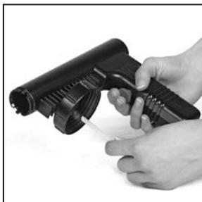
**2** Extraiga el tubo de lubricación y lávelo (asegúrese de volver a colocarlo cuando termine de limpiarlo).
