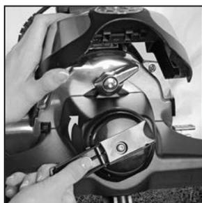
**10** Presione el sistema de lavado multisuperficie contra la unidad y gire el cierre auxiliar hacia la derecha para fijarlo en su sitio. Gire hacia la derecha el mecanismo de elevación de la correa del cabezal de lavado usando el mango hasta que se alineen las flechas verdes. Baje la cubierta de la luz frontal.
