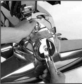
**4** Gire el cierre auxiliar hacia la izquierda para liberar el cabezal motorizado y extráigalo. Limpie las pelusas, cabellos o los residuos que pueda haber en el eje del motor.
