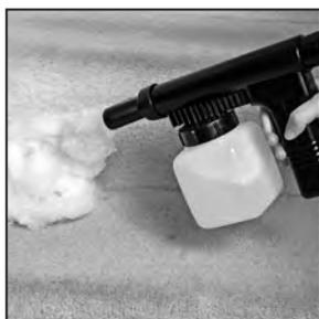
**4** Accendere l'unità e premere il grilletto per produrre schiuma. Ruotare il comando sul grilletto per regolare il volume della schiuma.
