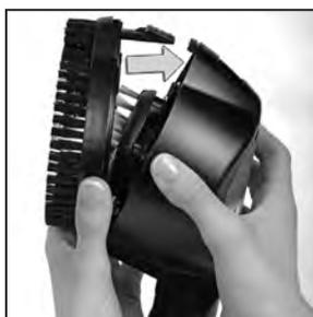
3 Riposizionare la turbina nello strumento e ruotarlo fino a quando le linguette si inseriscono nelle fessure. Riagganciare l'anello della spazzola in posizione.
