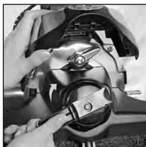
**10** Spingere il sistema di lavaggio multisuperficie contro l'unità e ruotare il blocco accessori in senso orario per fissarlo in sede. Utilizzare la maniglia sul corpo del sistema di lavaggio per ruotare l'alzacinghia in senso orario, fino ad allineare le frecce verdi. Abbassare la calotta con luce frontale.
