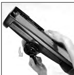
**7** Capovolgere il sistema di lavaggio multisuperficie. Spingendo verso l'alto la cinghia con il dito, utilizzare la maniglia per girare l'alzacinghia in senso antiorario, fino ad allineare le freccette rosse. Il gancio dell'alzacinghia afferrerà e tenderà la cinghia.
