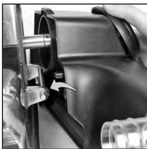
**10** Collegare i ganci sul retro del sistema di lavaggio multisuperficie alla barra di attacco.
