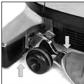
**1** Sollevare la parte anteriore dell'unità premendo il pedale inferiore sul Toe-Touch Control.
