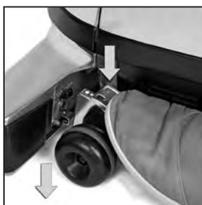
**3** Disinserire il servocomando Tech Drive®. Abbassare il corpo spazzola e aspirare il pavimento.
