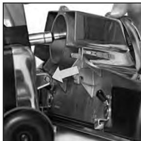
**7** Fissare i due ganci sul retro del corpo spazzola alla barra di attacco sulla parte anteriore dell'unità. Premere il corpo spazzola contro l'unità e fissarlo con il blocco accessori.
