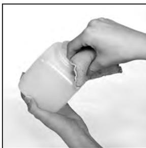
**1** Pulire lo spruzzatore portatile subito dopo l'uso. Svuotare il recipiente. Utilizzare SOLO acqua calda e sapone.
