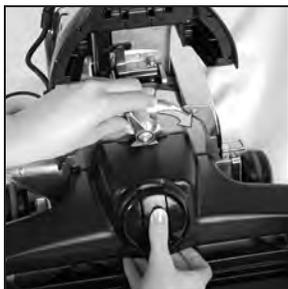
**11** Spingere il sistema di lavaggio multisuperficie contro l'unità e ruotare il blocco accessori in senso orario per fissarlo in sede.
