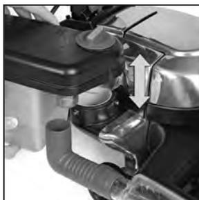
**17** Avendo cura di non versare liquidi sul sistema o sul pavimento, posizionare l'apertura posizionata sul fondo del serbatoio sulla bocca di scarico.
