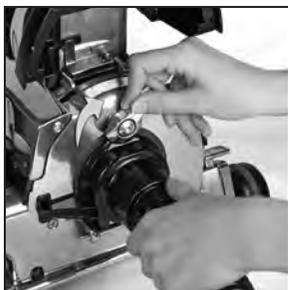
**5** Collegare i ganci del tubo di collegamento alla barra di attacco. Spingere l'apertura del tubo di collegamento contro l'unità. Ruotare il blocco accessori in senso orario per bloccarlo in posizione. Abbassare la calotta con luce frontale. Accendere l'unità.
