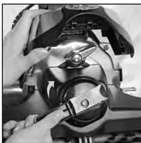
**12** Utilizzare la maniglia sul corpo del sistema di lavaggio multisuperficie per girare l'alzacinghia in senso orario, fino ad allineare le freccette verdi. Abbassare la calotta con luce frontale.
