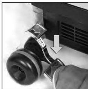
**6** Premere a fondo il pedale inferiore del Toe-Touch Control per sollevare la parte anteriore dell'unità. Sollevare la calotta con luce frontale.
