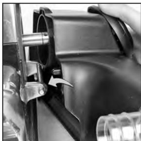
**9** Collegare i ganci sul retro del sistema di lavaggio multisuperficie alla barra di attacco.
