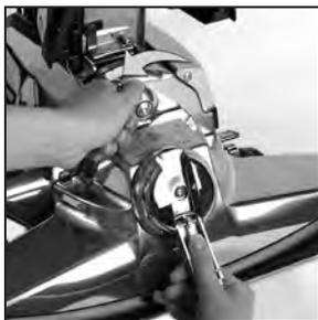
**4** Ruotare il blocco accessori in senso antiorario per sganciare il corpo spazzola. Sollevare ed estrarre il corpo spazzola. Eliminare ogni traccia di fili, capelli o detriti dall'albero motore.
