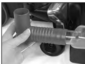
**16** Collegare saldamente il tubo a gomito al sistema di lavaggio multisuperficie.
