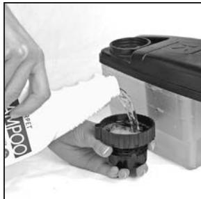
**15** Rezervoar za penu treba puniti i prazniti nad lavaboom. Odvrnite veliki zatvarač na vrhu rezervoara za penu. Okrenite regulator pene u položaj ISKLJUČENO. Napunite rezervoar topлом vodom (ne vrelom) prema tabeli ispod.
