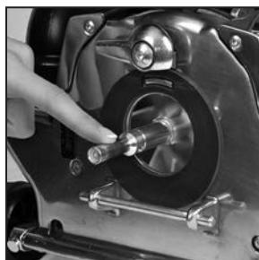
Vodite računa da na osovini motora nema vlakana, dlaka i naslaga prljavštine.
