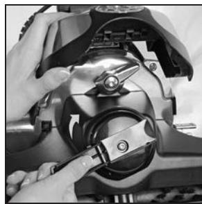
**12** Pomoću ručice okrenite podizač remena sistema za čišćenje površina penom u smeru kretanja kazaljke na satu sve dok se ne poklope zelene strelice. Sputite poklopac rasvetne kape.
