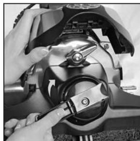
**10** Priljubite sistem za čišćenje površina penom uz uređaj i okrenite leptir-maticu u smeru kretanja kazaljke na satu tako da zabravi. Pomoću ručice okrenite podizač remena sistema za čišćenje površina penom u smeru kretanja kazaljke na satu sve dok se ne poklope zelene strelice. Spustite poklopac rasvetne kape.
