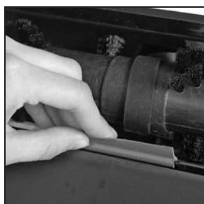
**8** Proverite da li je traka za odvajanje na svom mestu u podnožju sistema za čišćenje površina penom. Po potrebi umetnите traku za odvajanje.
