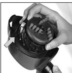
**2** Turbinu izvadite iz alata i uklonite čestice ili vlakna iz turbine i šupljine alata.
