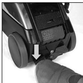
**3** Postavite uređaj na tepih. Prebacite Tech Drive® servo pogon u neutralni položaj pritiskom na levu "N" papučicu za neutralni položaj.
