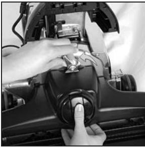
**6** Okrenite leptir-maticu u smeru suprotnom kretanju kazaljke na satu. Podignite sistem za čišćenje površina penom i odnesite ga do lavaboa.
