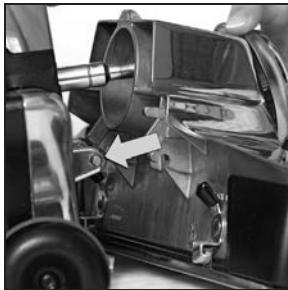
**7** Namestite dve kuke na poleđini usisne glave preko priključne šipke na prednjem delu uređaja. Priljubite usisnu glavu uz uređaj i pričvrstite je leptir-maticom.
