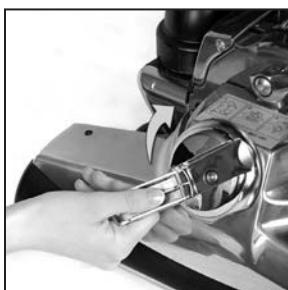
**8** Izvucite ručicu podizača remena i pomoću nje okrenite podizač remena u smeru kretanja kazaljke na satu dok se zelene strelice ne poklope. Time će remen biti u zahvatu i obrtna četka će se obrnati. Stranica 17. Spustite poklopac rasvetne kape.
