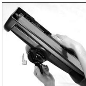
**7** Preokrenite sistem za čišćenje površina penom. Pridržavajući remen na mestu, okrenite ručicu podizača remena u smeru suprotnom kretanju kazaljke na satu dok se ne poklope crvene strelice. Kukica podizača remena zahvatiće i pritegnuti remen.
