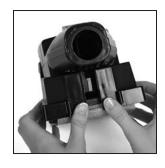
3 Com o acessório turbo em uma superfície nivelada, conecte novamente a cobertura contra pó do lixador com a abertura voltada para a parte traseira. Insira a mangueira de acoplamento.
