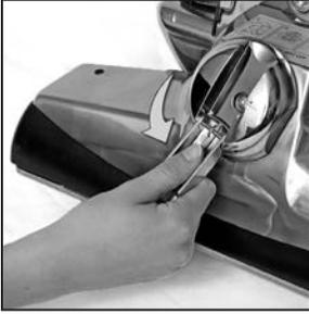
**3** Поднимите колпак. Откиньте ручку натяжителя ремня. С ее помощью прокрутите натяжитель против часовой стрелки до совмещения красных стрелок.
