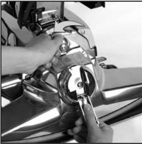
**4** Поверните фиксатор насадок против часовой стрелки, чтобы отсоединить электрощетку. Снимите электрощетку. Очистите вал двигателя от пуха, шерсти и мусора.
