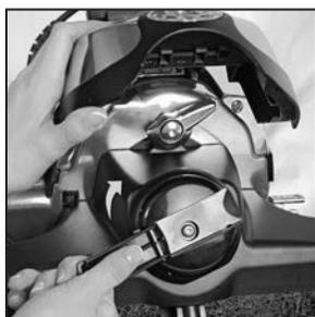
**10** Прижмите универсальную систему влажной уборки к аппарату и поверните фиксатор насадок по часовой стрелке, чтобы зафиксировать. С помощью ручки поверните натяжитель ремня щетки влажной уборки по часовой стрелке до совмещения зеленых стрелок. Опустите колпак.
