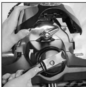
**12** С помощью ручки поверните натяжитель ремня щетки влажной уборки по часовой стрелке до совмещения зеленых стрелок. Опустите колпак.
