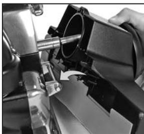
**4** Отсоедините электрощетку от аппарата. Зацепите крюки в задней части насадки за концы соединительного патрубка. С усилием вставьте насадку в отверстие системы. Поверните фиксатор насадок по часовой стрелке для фиксации.
