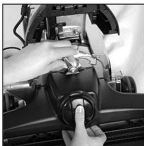
**11** Прижмите универсальную систему влажной уборки к аппарату и поверните фиксатор насадок по часовой стрелке, чтобы зафиксировать.
