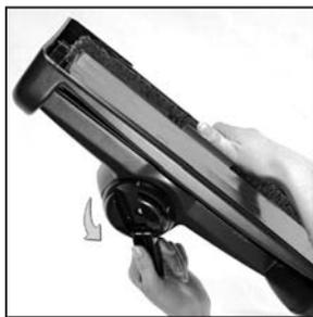
**7** Натягивая пальцем ремень, с помощью ручки натяжителя ремня поверните его против часовой стрелки до совмещения красных стрелок. Крюк натяжителя подцепит и натянет ремень.
