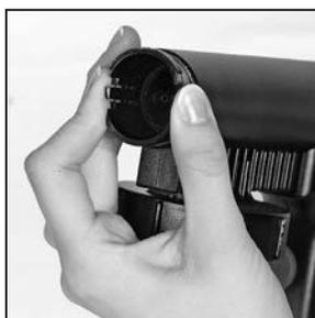
**3** Presione los dos seguros situados enfrente del chorro de la boquilla, tire de ellos y enjuáguelos a fondo. Llene el frasco con agua, vuelva a colocarlo y rocíe agua hasta que el rociado sea claro.
