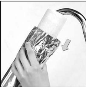
**7** Sujete la bolsa y el rodillo firmemente. Empuje el rodillo hacia la barra para comprimir el resorte de retención. Deslice el rodillo de cera y la bolsa. Cierre la bolsa firmemente. Guarde en un lugar seguro fuera del alcance de niños y mascotas hasta la próxima vez que lo use.
