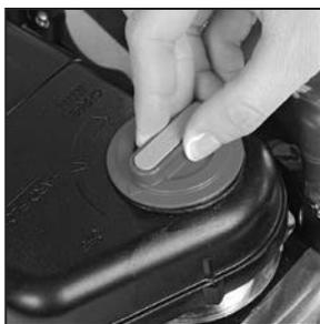
**1** Gire la válvula de control de espuma a la posición de apagado.
