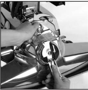
**4** Gire el seguro de accesorios hacia la izquierda para desenganchar la boquilla motorizada. Levante la boquilla motorizada. Limpie cualquier pelusa, cabello o residuo del eje del motor.
