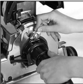
**5** Coloque los ganchos de la manguera de accesorios sobre la barra de sujeción. Empuje la abertura de la manguera de accesorios hacia dentro de la unidad. Gire el seguro de accesorios hacia la derecha para asegurarlo en su lugar. Baje la cubierta del foco delantero. Encienda la unidad.
