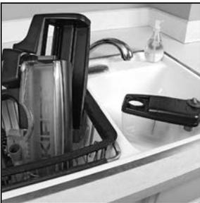
9 En el fregadero, deseche cualquier líquido sobrante del tanque de champú. Retire y limpie la tapa del filtro de espuma, la tapa y el filtro de esponja. Enjuague el tanque de champú con agua fría y vuelva a colocar la tapa del filtro, la tapa y el filtro de esponja. Deje que todas las partes se sequen completamente.
