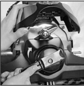
**12** Use el mango en el elevador de correa de la boquilla del champú para múltiples superficies para girarlo hacia la derecha hasta alinear las flechas verdes. Baje la cubierta del foco delantero.
