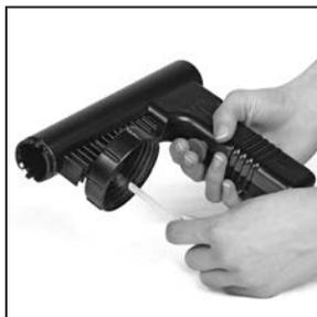
**2** Retire y lave el tubo sumergible. (Asegúrese de volver a instalarlo después de limpiarlo.)
