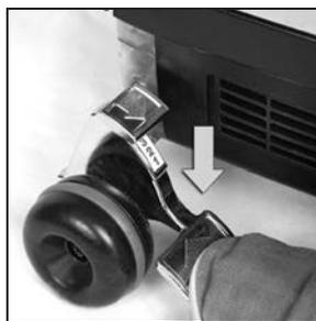
**6** Presione el pedal inferior del control Toe-Touch hasta el fondo para elevar la parte delantera de la unidad. Eleve la cubierta del foco delantero.
