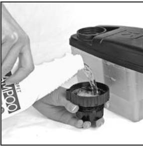
**15** El tanque de champú debe llenarse o vaciarse en un fregadero. Desatornille la tapa grande situada arriba del tanque de champú. Gire la válvula de control de espuma a la posición APAGADO. Llene el tanque con agua tibia (no caliente) según la siguiente tabla.
