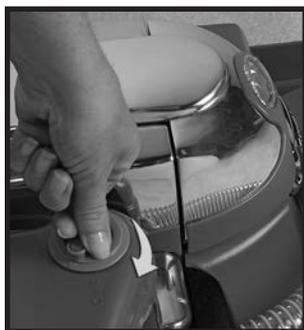
**2** Tourner la vanne de commande de mousse à fond vers la droite (sens du vissage) en position ON (marche). Mettre le système *Sentria* en marche et engager l'entraînement assisté TechDrive (voir page 8 pour plus de détails). La mousse commence immédiatement à s'écouler.
