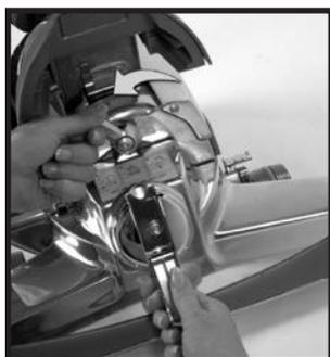
**2** Lever le capot de phare ⑳ et basculer la poignée en L sur le dégaugeur de courroie ㉑. L'utiliser pour tourner le dégaugeur de courroie à fond à gauche (sens du dévissage) jusqu'à ce que les flèches rouges soient alignées.
