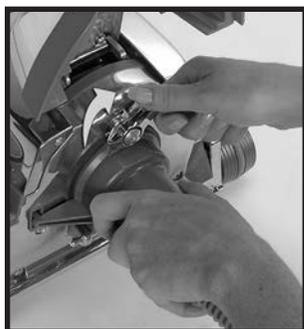
**5** Bloquer en position le connecteur du flexible de raccordement en tournant le verrouillage d'accessoire ㉔ complètement vers la droite (sens du vissage). (Le verrouillage d'accessoire va maintenir le flexible de raccordement sur l'appareil.) Abaisser ensuite le capot de phare.
