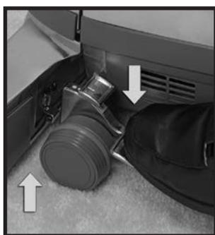
**5** Pour arrêter le système *Sentria*™, appuyer à fond sur la pédale inférieure de commande Toe-Touch Control ⑨ de façon à soulever entièrement l'électrobrosse tuyère.
