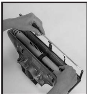
**3** Tirer sur le bord arrière de la plaque de tapis pour la retirer de l'électrobrosse.
