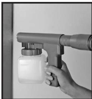
**3** Faire de lents mouvements de balayage pour pulvériser sur la zone voulue avec la solution. Toujours serrer la gâchette complètement, pour permettre un débit maximum. Cela fournit le meilleur contrôle de pulvérisation. ☐
