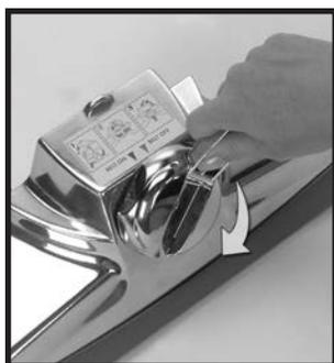
**2** Relâcher la tension de la courroie en utilisant la poignée sur le dégageur de courroie ②⑩ pour le tourner à fond à droite (sens horaire) jusqu'à ce que les flèches vertes soient alignées.
