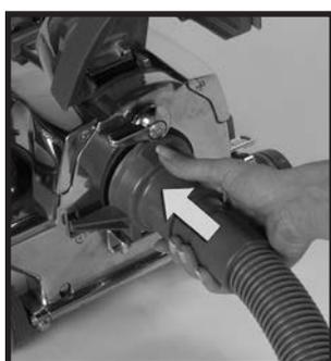
**4** À l'extrémité du connecteur du flexible de raccordement se trouvent deux protubérances en forme de crochet. Placer les crochets sur les extrémités de la barre de fixation ㉓ et pousser l'ouverture du flexible en la remontant contre le système *Sentria*. ➤
