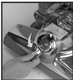
**2** Lever le capot de phare ⑳ et tourner la poignée sur le dégageur de courroie ㉑. L'utiliser pour tourner le dégageur de courroie complètement à gauche (sens du dévissage) jusqu'à ce que les flèches rouges soient alignées. ➤
