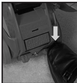
**4** Уколико желите, серво погон Tech Drive укључујете притиском стопала на крај папучице N/D ⑫ означен црвеним словом „D“ (Drive – погон), која се налази одмах испод прекидача за струју ⑬. ►
