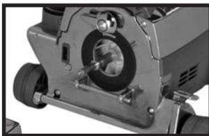
**Éviter l'accumulation de fibres, de cheveux et de débris à l'intérieur de l'arbre du moteur.** □
