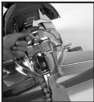
**2** Lever le capot de phare ⑳ et basculer la poignée en L sur le dégageur de courroie ㉑. L'utiliser pour tourner le dégageur de courroie à fond à gauche (sens du dévissage) jusqu'à ce que les flèches rouges soient alignées.
