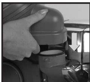
2 Pour replacer le collecteur Mini Em-Tor, rattacher l'ensemble du sac en insérant la languette (2) au sommet du sac dans la fente, sous le bouton de libération du sac (16).
