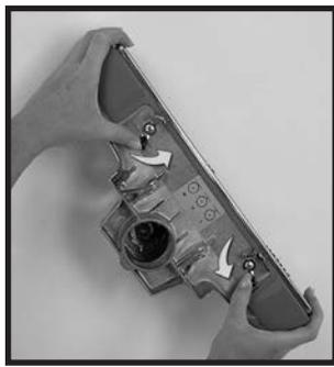
**2** Déverrouiller la plaque de tapis ㉔ en décrochant les deux loquets à l'arrière de l'électrobrosse. ➤
