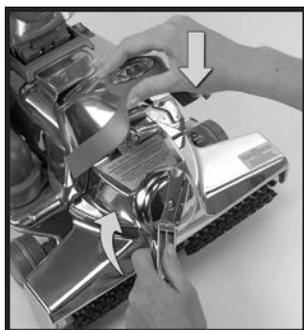
**6** Pour engager la courroie et la brosse de la cireuse, tourner la poignée du dégageur de courroie à fond vers la droite (sens horaire) jusqu'à ce que les flèches vertes soient alignées. Abaisser le capot de phare ㉑. ➤
