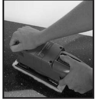
علق وسادة الصوف الصناعي باتباع نفس الإجراء لوصل أوراق السنفرة (انظر الصفحة 42). الآن أصبح جهاز الملحق التريبيني جاهزاً للصقل. استخدمه لتلميع الأسطح الصلبة المصقولة بالشمع مثل أسطح الطاولات، والصفائح والمساحات الكبيرة المسطحة. يمكن استخدامه لتلميع السيارات.
