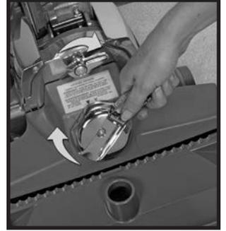
7 خزان الشامبو قابل للفصل ويجب تعبئته أو تفريغه في حوض المغسلة. ملحوظة: يُنزع خزان الشامبو ويعد وضعه بنفس الطريقة التي تتعامل بها مع حاوية Mini Em-Tor® (راجع التفاصيل في صفحة 10).
