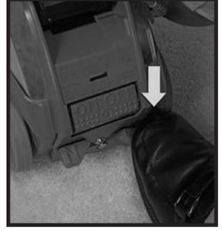
5 لإيقاف نظام *Sentria*™ OFF اضغط على الدواسة السفلى لـ Toe Touch Control ⑨ إلى أسفل تماماً حتى ترفع الفوهة تماماً. حرر Tech Drive المدعوم بالطاقة بالضغط على الجانب الرمادي اللون الذي به حرف N (للحيادي) الموجود على دواسة Tech Drive N/D ⑪. أطفئ *Sentria* بالضغط على مفتاح التشغيل ⑬ OFF ثم انزع القابض من مأخذ الكهرباء. □
