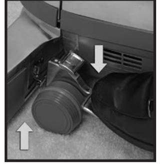
1 لتركيب خرطوم الوصلات يجب عليك أولاً تحويل المكنسة إلى مكنسة صندوقية بفصل فوهة الطاقة. لكي تفعل هذا، اضغط على الدواسة السفلى لـ Toe-Touch Control (9) إلى أسفل تماماً حتى ترفع الفوهة تماماً. حرر دواسة Tech Drive المدعومة بالطاقة بالضغط على الجانب الرمادي اللون الذي به حرف N (للحيادي) لدواسة Tech Drive N/D (14). أطفئ بالضغط على مفتاح OFF (13) ثم انزع القابض من مأخذ التيار الكهربائي. ◀
