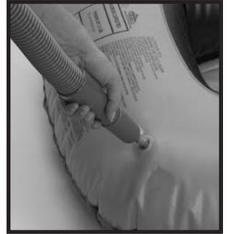
لتنفيس الأشياء المنفوخة، أوصل خرطوم الملحقات إلى مقدمة الوحدة ثم أوصل أداة النفخ/تفريغ الهواء إلى خرطوم الملحقات. ثم أوصل مجموعة الكيس إلى منفذ خروج الهواء.
