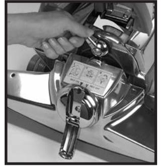
4 عند استخدام ملحقات النافخ، يجب وصل واقي مدخل الهواء إلى مقدمة الوحدة.
