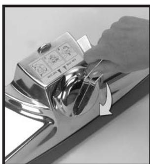
2 次に、ベルト・リフター<sup>⑳</sup>のハンドルを緑の矢印同士が揃うまで右方向（時計回り）に回転させ、ベルトをゆるめます。
