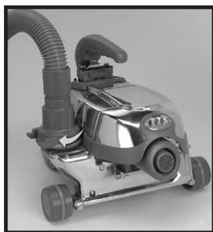
付属ホースの大きい方の端を排気口⑨に配置します。ホースの端にある矢印と排気口にある矢印を合わせ、ホース・コネクタを右に回して（時計回り）、ロックします。
