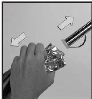
**5** パッキング・バッグとローラーをしっかりと握り、長いローラー・ワックス・ハンドルを引き抜きます。これには、ローラーをハンドル・グリップからバーの方向に押し、固定バネを押します。これで、ローラーがエンドキャップ上をスライドします。乾燥を防ぐため、バッグをしっかりと密封してください。付属のパッキング・チューブに入れ、次に使用するまで、お子様やペットの手の届かない安全な場所に保管しておきます。▶
