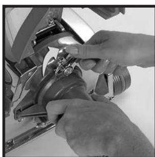
**5** アクセサリー・ロック<sup>⑰</sup>を右にいっぱいまで回し（時計回り）、付属ホース・コネクタをロックします。（アクセサリー・ロックによって、ホースが本体に固定されます。）次に、ヘッドライト・フードを下げます。
