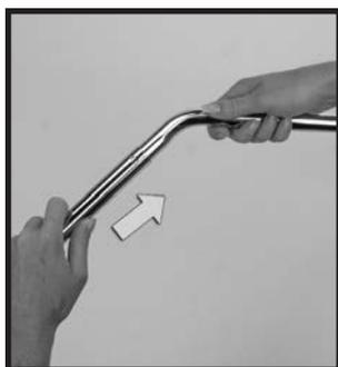
**6** 必要ならば、ハンドルの上部を鉤状の先端に向けて押しながら、下部にあるバネ式のピンを押し、長いワックス・ローラー・ハンドルを準備します。
