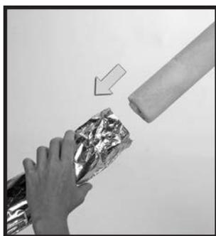
**4** ワックス・ローラーを長いハンドルから外すには、取っておいたパッキング・バッグの開いている端をローラーの方に向けて持ちます。ワックス・ローラーをパッキング・バッグの一番奥まで押し込みます。ワックスに触れないように注意してください。▶
