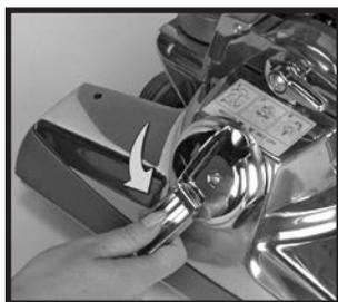
2 ベルト・リフター②のハンドルを写真のように取り出します。ハンドルを使用して、ベルト・リフターが止まり、赤い矢印同士が揃うまで左方向（反時計回り）に回転させます。これでベルトが伸び、リフトがモーター・シャフトから外れます。ベルト・リフターのハンドルを元に位置に戻します。
