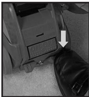
4 必要に応じて、Tech Drive® パワー・アシストを使用するには、電源スイッチ⑬の真下にある Tech Drive N/D ペダル⑫の赤い「D」ペダル（Dは Drive（ドライブ）の頭文字）を踏み下げます。▶
