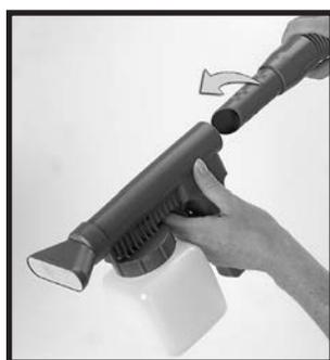
**3** ジャーをポータブル・スプレーヤーにしっかりと取り付けます。それから本体のホースにスプレーを取り付けます。
