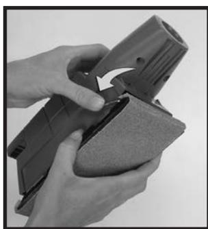
**4** Turbo Accessory の底部にサンドペーパーをきつく巻き付け、先端をリア・クランプ内に押し込みます。リア・クランプをロックします。▶
