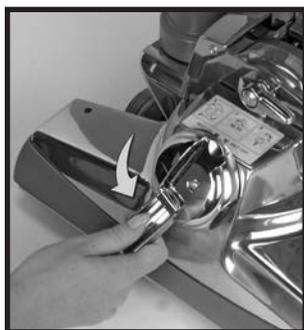
**2** ヘッドライト・フード㉑を上げ、ベルト・リフターのハンドル⑳を写真のように取り出します。ハンドルを使用して、ベルト・リフターを赤い矢印同士が揃うまで左（反時計回り）に回転させます。▶
