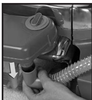
2 泡調節バルブを左 (反時計回り) に回し、オフの位置に合わせます。
