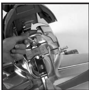
**2** ヘッドライト・フード<sup>⑯</sup>を上げて、ベルト・リフターのハンドル<sup>⑮</sup>を写真のように取り出します。ハンドルを使用して、ベルト・リフターを赤い矢印同士が揃うまで左方向（反時計回り）に回転させます。
