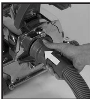
**4** ホースの接続部分にある2つのフックを取付けバー<sup>⑱</sup>の凹部分に引っかけてから、ホースの口を *Sentria* システムに押し当てます。▶
