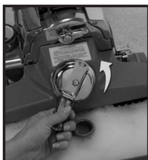
3 ヘッドライト・フード⑩を下げます。ベルト・リフターを赤い矢印同士が揃うまで左方向 (反時計回り) に回転させて、ベルトを外します。▶
