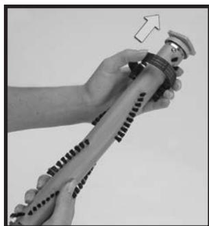
**4** ベルトをスライドさせて外し、新しいベルトと交換します。▶
