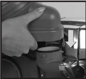
2 Mini Em-Tor コレクターを再び本体に取り付けるには、バッグ上部のバッグ・ラッチ・タブ②をバッグ・リリース・ボタン⑬下部のスロットに入れて、フィルター・バッグ・アセンブリを本体に取り付けます。
