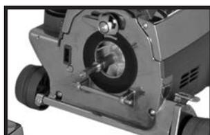
糸くず、毛髪、たまったゴミがモーターの軸に触れないようにしてください。
