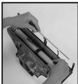
**3** ラグ・プレートの後ろのエッジを引いて、ノズルから外します。
