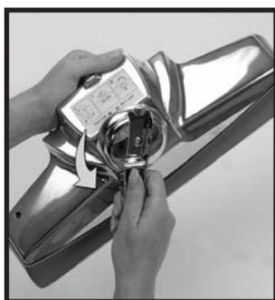
**7** ベルト・リフター⑳を使って、赤い矢印同士が揃うまで左方向（反時計回り）に回転させます。これで、ベルトが引き伸ばされて *Sentria*™システムにノズルを取り付ける準備ができました。
