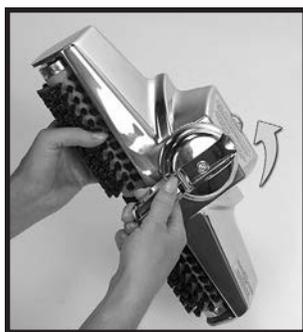
**4** 指でベルトを押し上げた状態で、ベルト・リフターのハンドルを使用して、赤い矢印同士が揃うまで左方向（反時計回り）に回転させます。ベルト・リフターのフックがベルトをとらえ、ベルトがノズルの上部に向かって伸びます。▶
