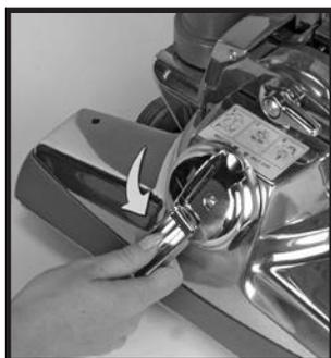
直接吸引型クリーナーとして使用するには、ヘッドライト・フード①を上げて、ベルト・リフターのハンドル②を写真のように取り出します。ハンドルを使用して、ベルト・リフターを赤い矢印同士が揃うまで左方向（反時計回り）に回転させます。これで、ブラシ・ロールの回転が止まります。
