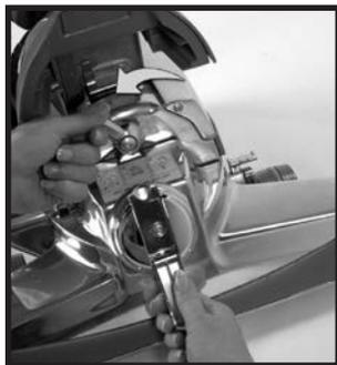
**2** Levante la cubierta del foco delantero 21 y mueva el mango en forma de L del elevador de correa 20. Uselo para girar todo el elevador de correa hacia la izquierda (en sentido contrario a las agujas del reloj) hasta que las flechas rojas estén alineadas.
