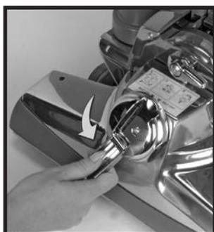
**2** Levante la cubierta del foco delantero 21 y mueva el mango del elevador de correa 20. Use para girar el elevador de correa todo hacia la izquierda (contrario a las agujas del reloj) hasta que se alineen las flechas rojas. ➤
