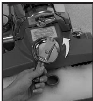
**3** Levante la cubierta del foco delantero ⑩. Desenganche la correa girando el elevador de correa hacia la izquierda (en sentido contrario a las agujas del reloj) hasta que se alineen las flechas rojas. ➤
