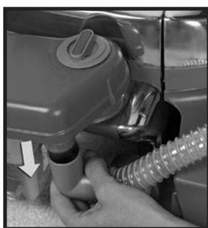
**2** Gire la válvula de control de espuma completamente hacia la izquierda (contrario a las agujas del reloj) a la posición APAGADO.
