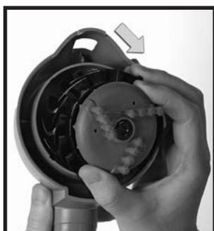
**2** Levante el cepillo central/turbina de aire fuera de la herramienta y elimine todas las partículas o pelusa, del cepillo y de la turbina. Elimine también todas las partículas depositadas en la cavidad de la herramienta. ➤
