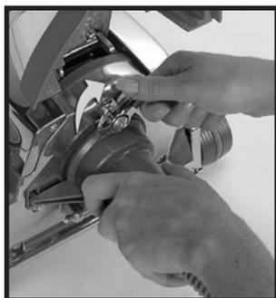
**5** Calce el conector de la manguera en su lugar girando el seguro de accesorios 22 todo hacia la derecha (en sentido de las agujas del reloj). (El seguro de accesorios sujetará la manguera a la unidad). A continuación baje el capó de los faros.
