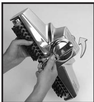
**4** Mientras sujeta la correa en su lugar, use el mango del elevador de correa para girarlo a la izquierda (en sentido contrario a las agujas del reloj) hasta que se alineen las flechas rojas. El gancho del elevador de correa atraparé la correa y la estirá hacia arriba dentro de la boquilla. ➤
