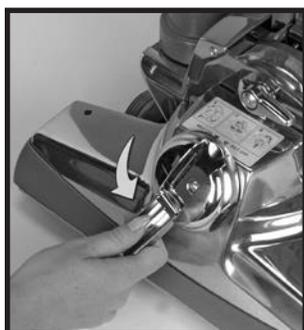
Para aspiración directa, eleve la cubierta del foco delantero ⑳ y mueva el mango en forma de L del elevador de correa ㉑. Use lo para girar el elevador de correa todo hacia la izquierda (en sentido contrario a las agujas del reloj) hasta que se alineen las flechas rojas. Esto detendrá el giro del rodillo de cepillo.
