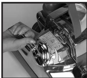
**4** Para volver a enganchar la correa de manera que gire el rodillo de cepillo, simplemente eleve la cubierta del foco delantero y use el mango para girar el elevador de correa completamente a la derecha (en el sentido de las agujas del reloj) hasta que se alineen las flechas verdes. A continuación baje la cubierta del foco delantero.
