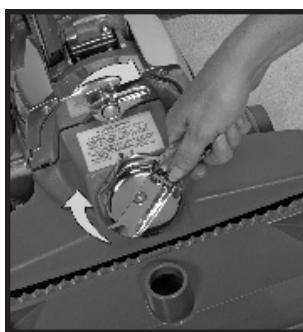
**6** Pridignite glavu uz jedinicu i zavrnite leptir maticu ㉒ udesno (u smjeru kazaljki na satu) da zategnete glavu. Da biste uključili remen, ručicom podizača remena zakrenite podizač sasvim udesno (u smjeru kazaljke na satu) da se poklope zelene strelice. Potom spustite rasvjetnu kapu ㉑.
