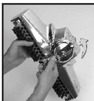
**4** Pridržavajući remen na njegovom mjestu, ručicom podizača remena zakrenite podizač sasvim udesno (u smjeru kazaljke na satu) da se poklope crvene strelice. Kukica podizača remena zahvatit će remen i zategnuti ga uz glavu.
