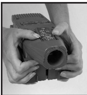
**5** Na ravnu plohu postavite alat i na nj plašt za zaštitu od prašine, tako da otvor dođe straga, te ga stisnite da se zatvori.
