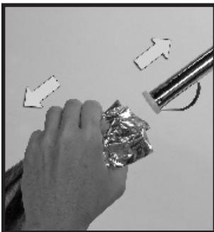
**5** Uhvatite čvrsto i vreću za pakiranje i valjak pa ih izvucite s dugačke drške valjka za voštenje. Da biste to učinili, povucite valjak od drške prema šipki jer ćete tako stisnuti zadržavajuću oprugu. To će Vam omogućiti povlačenje valjka preko poklopca na kraju. Čvrsto zatvorite vreću da se spriječi preuranjeno sušenje. Spremite u priloženu cijev za pakiranje i do sljedeće upotrebe odložite na sigurno mjesto, podalje od djece i kućnih ljubimaca.
