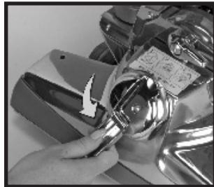
**2** Izvucite ručicu na podizaču remena ⑪. Pomoću nje okrenite podizač remena do kraja ulijevo (u smjeru suprotnom kazaljki na satu) sve dok se ne zaustavi i crvene se strelice poklope. Na taj se način remen rasteže i odvaja od osovine motora. Vratite ručicu na podizaču remena u položaj u kojem je zatvorena.
