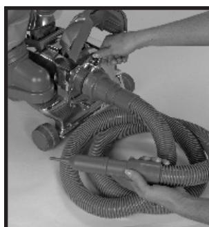
Ako želite ispuhivati predmete, priključite usisno crijevo s prednjestrane jedinice i na njega postavite nastavak za napuhavanje/ispuhivanje.
