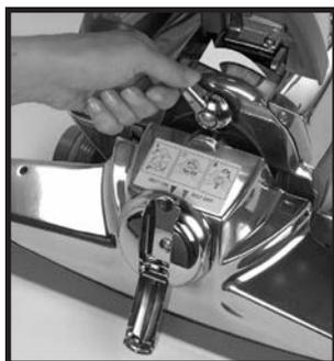
**3** Déverrouiller l'électrobrosse ⑫ en tournant le verrou d'accessoire ⑫ à fond à gauche (sens du dévissage). L'électrobrosse doit basculer vers l'avant lorsqu'elle est relâchée. Soulever l'électrobrosse du système *Sentria*. ➤
