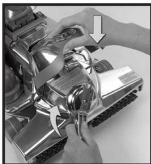
**6** Pour engager la courroie et la brosse de la cireuse, tourner la poignée du dégageur de courroie à fond vers la droite (sens horaire) jusqu'à ce que les flèches vertes soient alignées. Abaisser le capot de phare ①. ►
