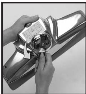
**7** En utilisant la poignée en L sur le dégageur de courroie ①, le tourner à gauche (sens du dévissage) jusqu'à ce que les flèches rouges soient alignées. Cela permet d'étirer la courroie en préparation du retour de la brosse dans le système *Sentria*<sup>TM</sup>.
