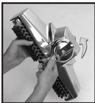
**4** Tout en maintenant la courroie en place, utiliser la poignée en L sur le dégaugeur de courroie pour le tourner à gauche (sens du dévissage) jusqu'à ce que les flèches rouges soient alignées. Le crochet du dégaugeur de courroie attrape la courroie et l'étire dans le suceur. ➤
