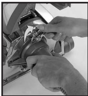
**5** Bloquer en position le connecteur du flexible de raccordement en tournant le verrouillage d'accessoire ⑫ complètement vers la droite (sens du vissage). (Le verrouillage d'accessoire va maintenir le flexible de raccordement sur l'appareil.)
