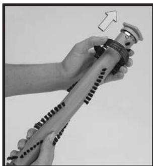
**4** Sortir en la glissant l'ancienne courroie et la remplacer par une neuve. ➤
