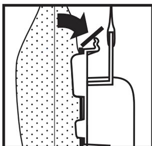
**3** Plier les languettes en carton en haut de la plaque en les insérant dans les supports situés en haut de l'adaptateur supérieur.
