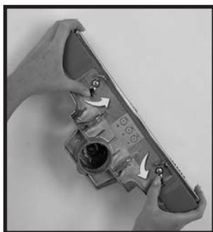
**2** Déverrouiller la plaque de tapis ⑳ en décrochant les deux loquets à l'arrière de l'électrobrosse. ➤
