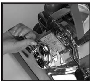
**4** Pour réengager la courroie et faire tourner le rouleau-brosse, lever simplement le capot de phare et utiliser la poignée pour tourner le dégageur de courroie à fond vers la droite (sens horaire) jusqu'à l'alignement des flèches vertes. Puis rabaisser le capot de phare.
