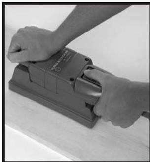
**6** Insérer le flexible dans l'extrémité de l'accessoire turbo. Tenir la ponceuse à l'avant et à l'arrière et mettre le système *Sentria*<sup>TM</sup> en marche. Puis appuyer sur le bouton de mise en marche sur le dessus de la ponceuse.
