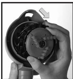
**2** Soulever la brosse centrale et la turbine à air hors de l'outil, retirer la brosse et la turbine et les particules et peluches. Enlevez aussi les particules qui restent dans la cavité de l'outil. ➤
