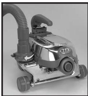
**6** Placer la grande extrémité du flexible de raccordement sur l'orifice de sortie d'air **10**. Aligner leurs flèches indicatrices et tourner le connecteur de flexible vers la droite (sens du vissage) pour le bloquer en position.
