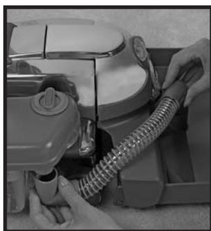
**9** Pousser le coude rond du petit tuyau flexible dans le trou du plateau jusqu'à ce qu'il s'emboîte en place. Insérer fermement l'autre extrémité sur le raccord sur l'avant bas du réservoir à shampooing. ◻
