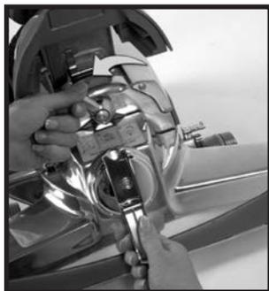
**2** Lever le capot de phare ⑪ et basculer la poignée en L sur le dégageur de courroie ⑩. L'utiliser pour tourner le dégageur de courroie à fond à gauche (sens du dévissage) jusqu'à ce que les flèches rouges soient alignées.
