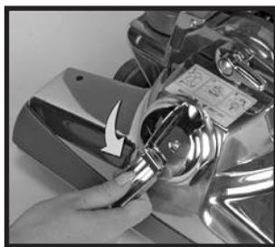
**2** Basculer la poignée sur le dégageur de courroie ①. L'utiliser pour tourner le dégageur de courroie complètement à gauche (sens du dévissage) jusqu'à ce qu'il vienne buter et que les flèches rouges soient alignées. Cela étire la courroie et l'entraîne loin de l'arbre moteur. Ramener la poignée sur le dégageur de courroie en position fermée.
