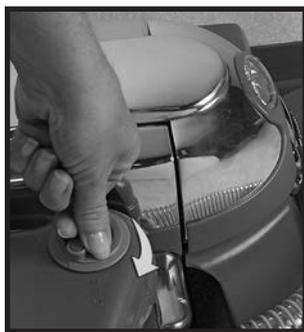
**2** Gire a Válvula de Controle de Espuma totalmente para a direita (no sentido horário) até à posição ON. LIGUE o *Sentria* e active o Tech Drive<sup>®</sup> Power Assist (consulte a página 8 para obter informações). O fluxo de espuma começará imediatamente.
