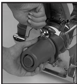
**4** Quando se usa os acessórios do insuflador, é necessário encaixar a Protecção da Entrada de Ar na frente do aparelho.
