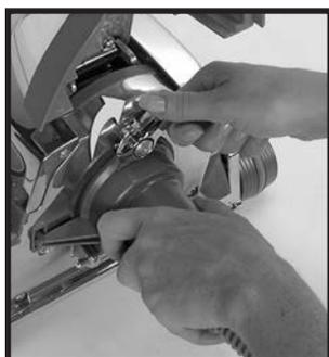
**5** Encaixe o Conector da Mangueira para Acessórios girando a Trava de Acessório 22 totalmente para a direita (no sentido horário). (A Trava de Acessório prenderá a Mangueira para Acessórios ao aparelho).
