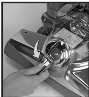
Para a limpeza por sucção directa, levante a Tampa da Luz Frontal ② e puxe para fora a alavanca em forma de L no Elevador da Correia ⑩. Use-a para girar o Elevador da Correia totalmente para a esquerda (no sentido anti-horário) até que as setas vermelhas fiquem alinhadas. Desse modo, a Escova Cilíndrica deixará de girar.
