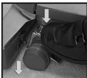
Ligue o aparelho e pressione o Pedal Superior do Toe-Touch Control 4 vezes (uma posição de cada vez) até aparecer o número 3 na frente do Pedal Superior do Toe Touch Control. Está na posição **MAIS ALTA** de limpeza, usada para tapetes de pêlo alto.
