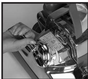
**4** Para encaixar a correia novamente de modo a que a Escova Cilíndrica possa girar, basta levantar a Tampa da Luz Frontal e usar a alavanca para girar o Elevador da Correia totalmente para a direita (no sentido horário) até que as setas verdes fiquem alinhadas. Em seguida, abaixe a Tampa da Luz Frontal.
