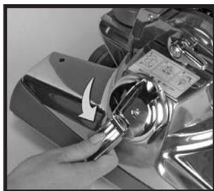
**2** Puxe para fora a alavanca do Elevador da Correia ①. Use-a para girar o Elevador da Correia totalmente para a esquerda (no sentido anti-horário) até que ele pare de girar e as setas vermelhas fiquem alinhadas. Isso estica a correia e eleva-a do eixo do motor. Volte a colocar a alavanca do Elevador da Correia na posição fechada.
