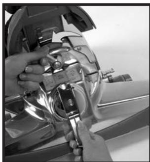
**2** Levante a Tampa da Luz Frontal 21 e puxe para fora a alavanca em forma de L no Elevador da Correia 11. Use-a para girar o Elevador da Correia totalmente para a esquerda (no sentido anti-horário) até que as setas vermelhas fiquem alinhadas.
