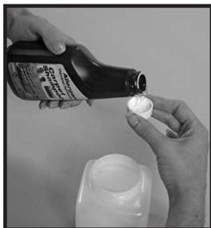
**2** Отсоедините емкость от портативного распылителя и наполните ее примерно на 3/4 фирменной смесью Kirby® для мокрой чистки ковров (смесь приготовьте согласно инструкции на бутылке). Для достижения оптимальных результатов пользуйтесь исключительно ковровым шампунем фирмы KIRBY. ►
