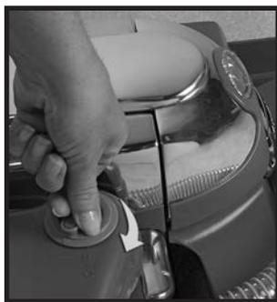
**2** Поверните регулятор пены до конца вправо (по часовой стрелке), установив его в положение ON (ВКЛ.) Включите питание системы *Sentria*, а также привод колес Tech Drive (подробнее см.стр.8). Пена сразу же начнет вытекать.
