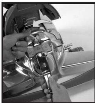
**2** Поднимите колпак ⑮ и откиньте ручку на натяжителе ремня ⑯. С ее помощью поверните натяжитель ремня влево до упора (против часовой стрелки) до совпадения красных стрелок.
