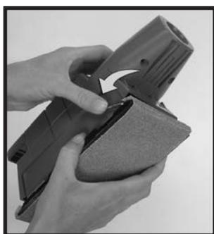
**4** Плотнo оберните бумагой нижнюю часть Турбонасадки и воткните конец в зажим на обратной стороне. Зафиксируйте зажим. ➤
