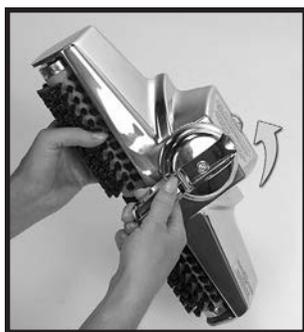
**4** Удерживая ремень на месте, с помощью ручки на натяжителе ремня поверните натяжитель влево (против часовой стрелки) до совпадения красных стрелок. Сработает фиксатор натяжителя ремня и вытянет ремень вверх в насадку. ➤
