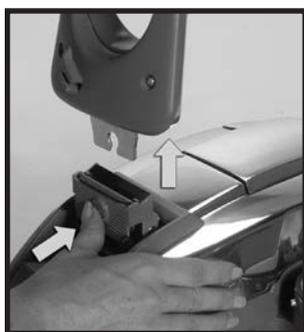
**2** Вытяните шнур из рукоятки. Поставив манипулятор в вертикальное положение (17), нажмите на кнопку отпускания ручки (14), расположенную у основания манипулятора, и, вытяните его из отверстия, удерживая в вертикальном положении. (мешок не показан для ясности). ➤
