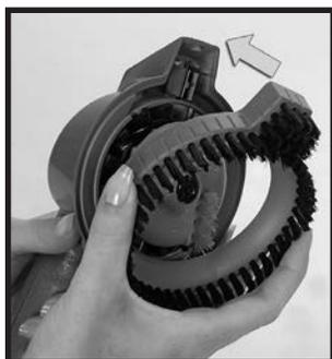
**3** Вставьте обратно щетку с воздушной турбиной в насадку и поверните, чтобы язычки вошли в пазы. Зацепите язычок на обратной стороне кольцевой прокладки щетки в маленькое отверстие на насадке и зафиксируйте. □
