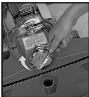
**6** Прижмите щетку к устройству и поверните защелку ㉒ вправо (по часовой стрелке), зафиксировав ее. Чтобы вытянуть ремень, поверните ручку натяжителя ремня вправо (по часовой стрелке) до совпадения зеленых стрелок. Теперь опустите колпак ㉑. ➤
