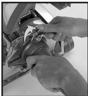
**5** Закрепите разъем удлинительного шланга, повернув фиксатор насадок ⑰ вправо (по часовой стрелке) до упора. (фиксатор насадок прижмет удлинительный шланг к устройству).
