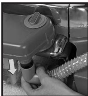
**2** Поверните регулятор пены до конца влево (против часовой стрелки), до положения OFF (ОТКЛ.) ➤
