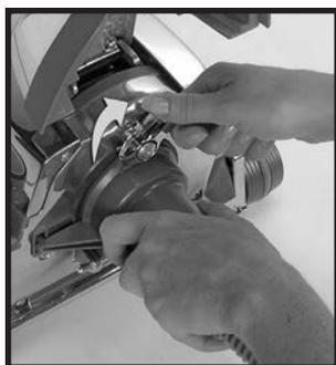
**5** Calce el conector de la manguera en su lugar girando el seguro de accesorios 22 todo hacia la derecha (en sentido de las agujas del reloj). (El seguro de accesorios sujetará la manguera a la unidad).
