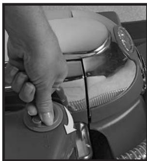
**2** Gire la válvula de control de espuma toda a la derecha (en el sentido de las agujas del reloj) hasta a la posición ENCENDIDO. ENCIENDA el sistema *Sentria* y enganche la asistencia motorizada Tech Drive<sup>®</sup> (vea la página 8 para conocer más detalles). Comenzará inmediatamente el flujo de espuma.
