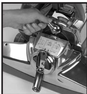
**3** Desenganche la Boquilla Motorizada 25 girando el seguro de accesorios 22 todo hacia la izquierda (en sentido contrario a las agujas del reloj). La boquilla motorizada debe inclinarse hacia adelante cuando se desengancha. Levante la boquilla para alejarla del sistema *Sentria*. ➤
