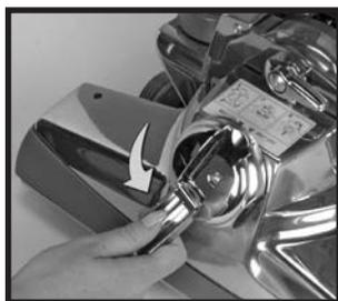
**2** Mueva el mango del elevador de correa ⑳. Uselo para girar el elevador de correa completamente hacia la izquierda (sentido contrario a las agujas del reloj) hasta que se detenga y se alineen las flechas rojas. Esto estira la correa y la levanta del eje del motor. Retorne el mango del elevador de correa a su posición cerrada.
