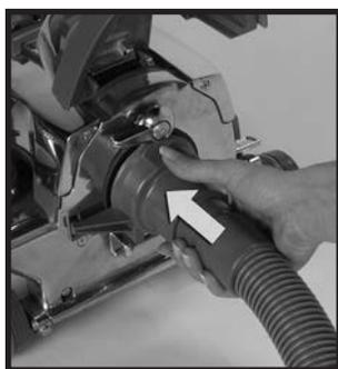
**4** Usted notará dos aletas en forma de gancho en el extremo del conector de la manguera. Enganche las aletas sobre los extremos de la barra de fijación 24, a continuación presione la abertura contra el sistema *Sentria*. ➤
