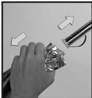
**5** Sujete firmemente la bolsa de empaque y el rodillo y tírelos hacia afuera del mango largo del encerador de rodillo. Para hacerlo, empuje el rodillo alejado de la empuñadura del mango hacia la barra para comprimir el resorte retenedor. Esto le permitirá deslizar el rodillo sobre la tapa del extremo. Selle bien la bolsa para evitar un secado prematuro. Almacene en el tubo de empaque provisto y colóquelo en un lugar seguro alejado de los niños y animales domésticos hasta el próximo uso. ➤
