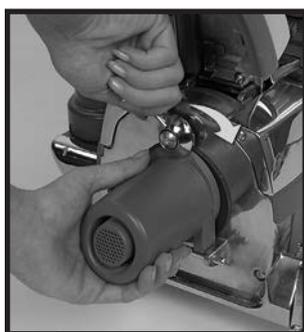
**4** Al usar la herramienta de soplador, el protector de toma de aire debe fijarse al frente del sistema *Sentria*.
