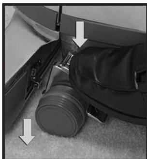
**3** Presione el pedal superior del Control Toe-Touch, 4 veces. Ahora está en la posición para limpieza de pisos **MÁS ALTA** (indicada por el No. 3 que se muestra en la parte frontal del pedal superior del Control Toe-Touch). Presione el pedal otra vez para alfombras de cerda de mediana altura (indicado por el No. 2) y otra vez para las alfombras de cerda de baja altura (indicado por el No. 1.) ➤
