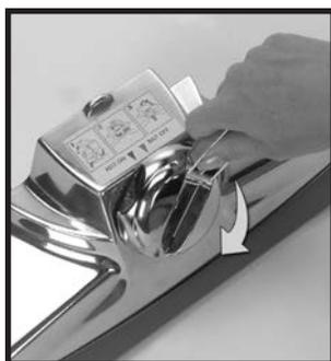
**2** Afloje la tensión de la correa usando el mango del elevador de correa 20 para girarlo totalmente hacia la derecha (en el sentido de las agujas del reloj) hasta que se alineen las flechas verdes.
