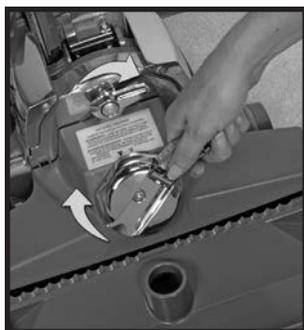
**6** Empuje la boquilla hacia arriba contra la unidad y gire el seguro de accesorio **22** a la derecha (en el sentido de las agujas del reloj) para calzar la boquilla en su lugar. Para enganchar la correa use el mango del elevador de correa para girarlo totalmente hacia la derecha (en el sentido de las agujas del reloj) hasta que se alineen las flechas verdes. A continuación baje la cubierta del foco delantero **21**. ➤
