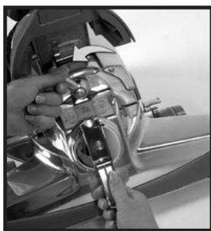
**2** Levante la cubierta del foco delantero 21 y mueva el mango en forma de L del elevador de correa 20. Úselo para girar todo el elevador de correa hacia la izquierda (en sentido contrario a las agujas del reloj) hasta que las flechas rojas estén alineadas.
