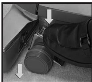
Encienda la unidad y presione el pedal superior del control Toe-Touch 4 veces (una muesca a la vez) hasta que vea el número 3 en la parte frontal del pedal superior del control Toe Touch. Ahora debe estar en la posición **MÁS ALTA** de limpieza de pisos que se utiliza para alfombras de felpa densa y cerda alta.
