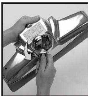
**7** Usando el mango en forma de L en el elevador de correa 20, gire hacia la izquierda (en sentido contrario a las agujas del reloj) hasta que se alineen la flechas rojas. Esto estirará la correa en preparación para retornar la boquilla al sistema *Sentria*™.
